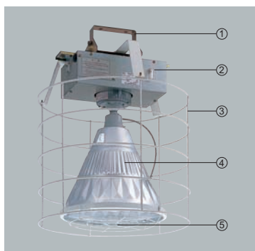
Combination example ① Metal parts for protector : IA55 ② Device : UDM41272 ③ Protector : TGS413A ④ Shade : KNW411D3 ⑤ Guard : GSAW41
